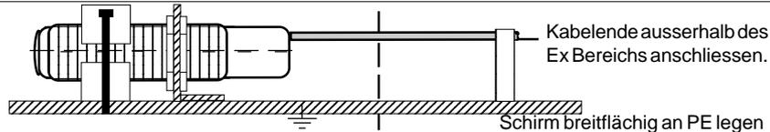
Örtlichen Potenzialausgleich des Gehäuses mittels Muttern oder Klemmschelle korrosionsbeständig sicherstellen.
