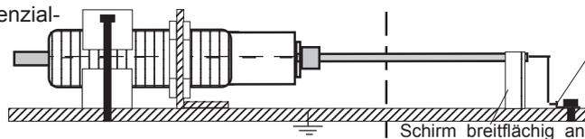
Kabelende ausserhalb des Ex Bereichs anschliessen. Örtlichen Potenzialausgleich mittels PA-Anschluss korrosionsbeständig und dauerhaft sicherstellen.
